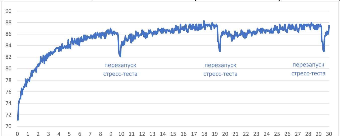
Рис. 12. Температура микропроцессора (°C), цикл T = +50°C, t = 30 мин.
