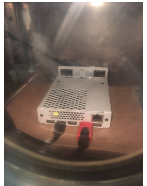
Рис. 6. Размещение Изделия в камере. Вид через смотровое окно камеры.
