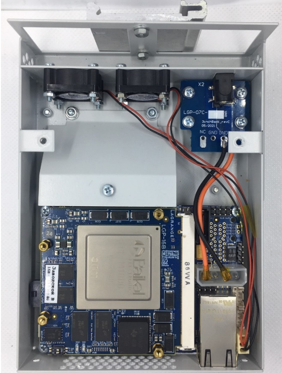
Рис. 3. Общий вид Изделия, без крышки, без радиатора
