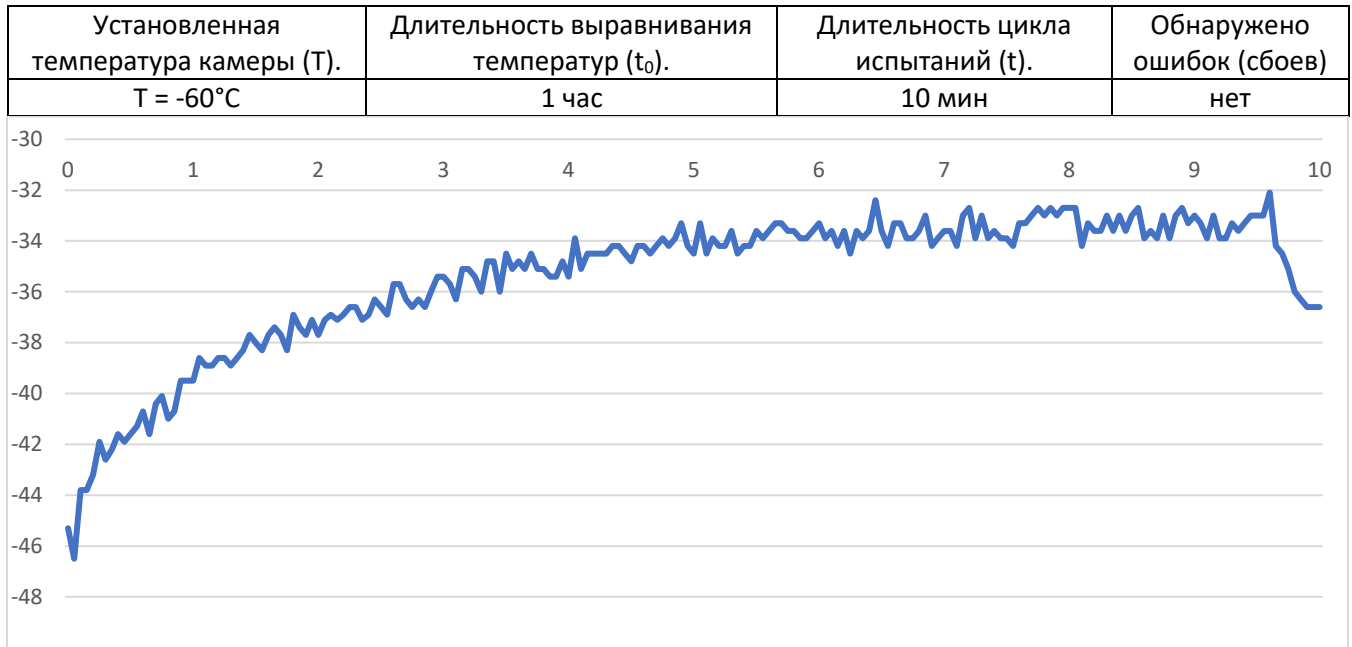
Рис. 9. Температура микропроцессора (°C), цикл Т = -60°C, t_0 = 1 час, t = 10 мин.
